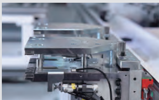
由CNC控制的动态夹钳系统
