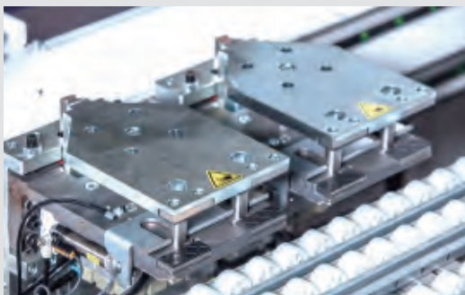
机器两边均有CNC控制的动态夹钳系统
